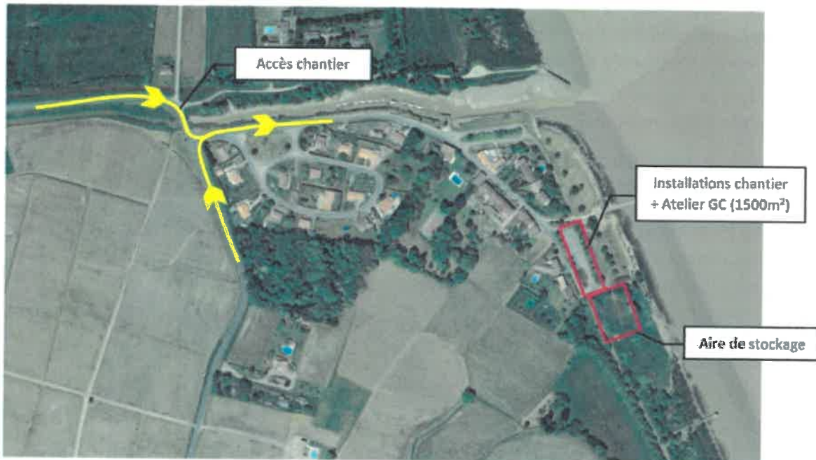
Fig 2 : Localisation des accès et installations de chantier
